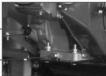
Рис. 10 Проверка уровня масла в картере
